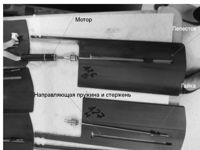
Рис. 2. Лепестки, моторы, гайки, направляющие пружины и стержни МЛК при демонтаже и полной разборке
