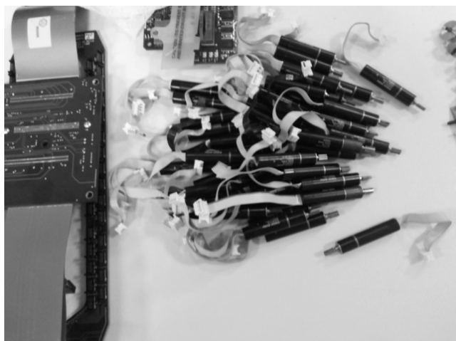
Рис. 1. Моторы МЛК при демонтаже и полной разборке
