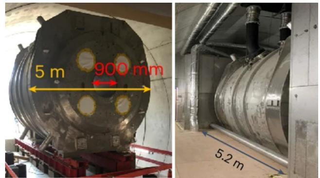
**Рис. 19.** Схема и внешний вид магнитной системы Iseult, показывающая основную катушку и две активные экранирующие катушки. Магнит весит 132 тонны, имеет внешний диаметр и общую длину около 5 м, диаметр рабочего туннеля составляет 90 см [96, 102]
