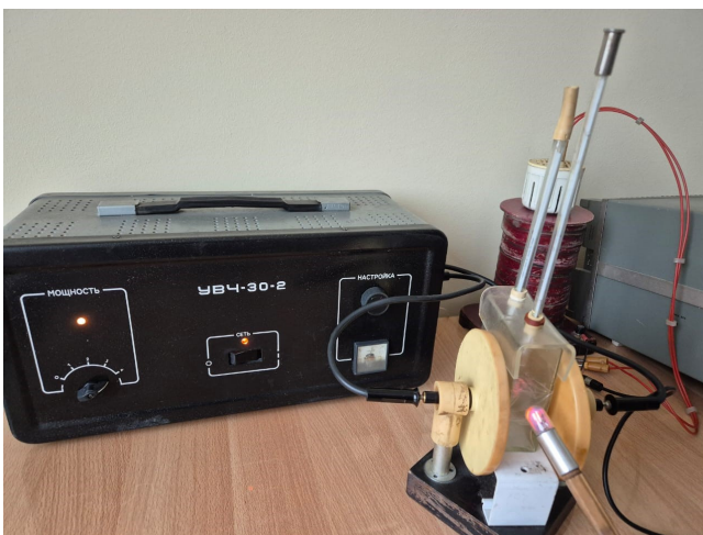
Рис. 1. Установка для исследования влияния УВЧ поля на проводники и диэлектрики
