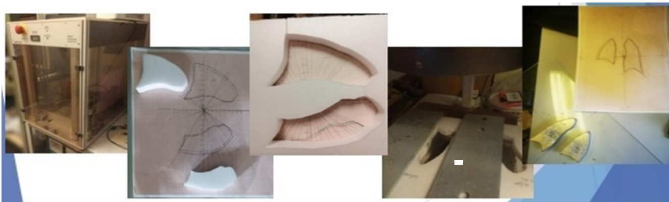
Рис. 8. Фабрика блоков слева направо: система для вырезания формы блока (матрицы) в пенопласте EASY-CUT; выкройка для отливки с наложенной на нее матрицей; отлитые блоки из церробенда
