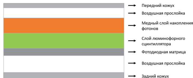
Рис. 1. Основные компоненты EPID панели на основе аморфного кремния a-Si
