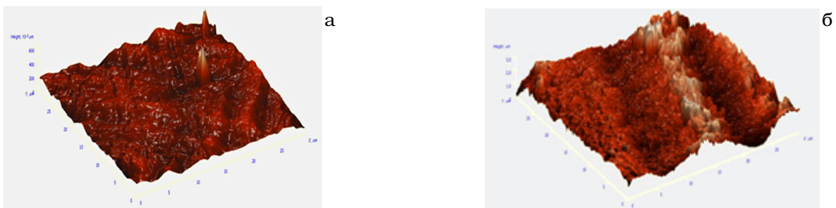
Рис. 8. АСМ-изображения структур коллагеновых фибрилл после комбинированного воздействия: а – 12 кГр, б – 20 кГр
