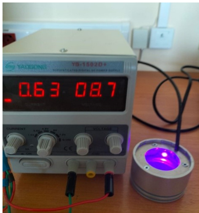
Рис. 1. Установка для облучения фотосенсибилизатора
