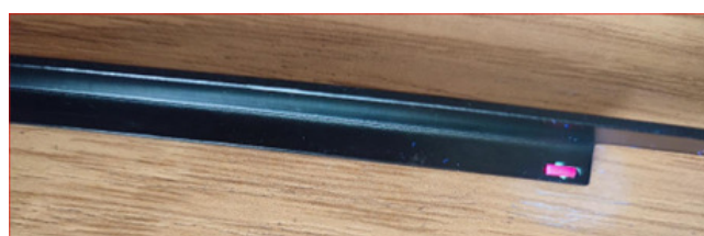
Рис. 1. Флуоресцентный оптический кристалл, закрепленный в планке
