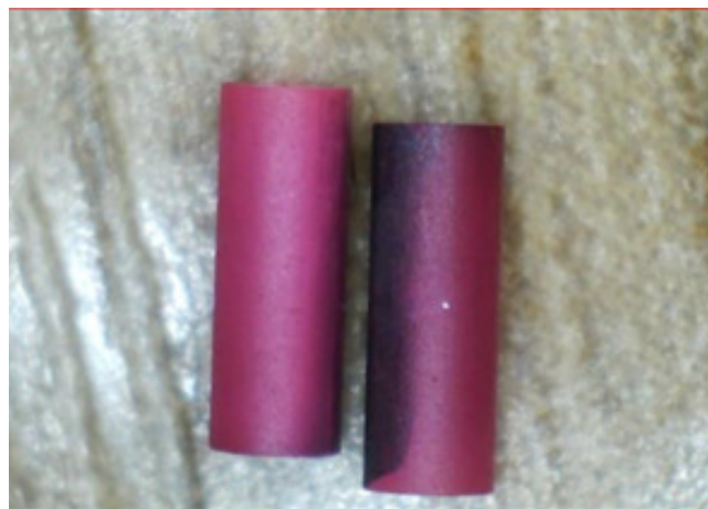
Рис. 2. Флуоресцентные оптические кристаллы – целый и вышедший из строя: а) слева – целый кристалл, справа – вышедший из строя, четко видна область затемнения в поле люминесценции с длиной волны в 395 нм; б) слева целый кристалл, справа – вышедший из строя, четко видна область затемнения при естественном освещении
