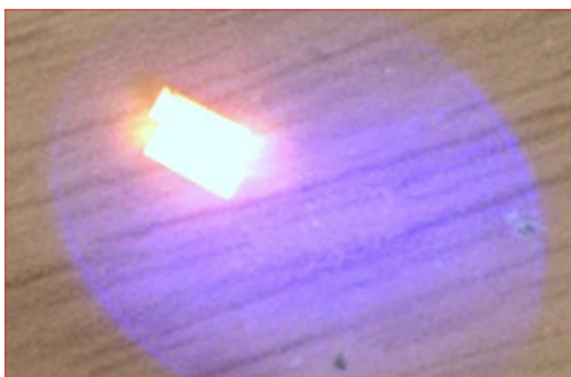
Рис. 3. Флуоресцентный оптический кристалл, люминесцирующий в ближнем ультрафиолете
