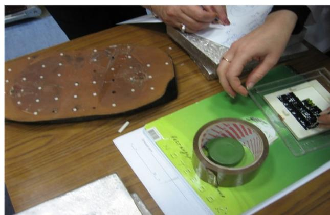
**Рис. 13.** а – антропоморфный человекоподобный фантом Alderson Rando с контрольными пластинами № 14, 26, 33, в которые были уложены ТЛД; б – контрольные пластины фантома, в которых предусмотрены специальные технологические отверстия для размещения в них ТЛД и в которые укладываются ТЛД в равновесных колпачках
