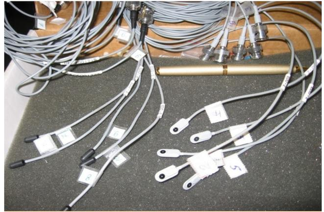
**Рис. 16.** Электронметр с ИК (вверху) (а) и шестиканальный дозиметр DPD6 (внизу) (а) в комплекте с ППД. Полупроводниковые детекторы (б)
