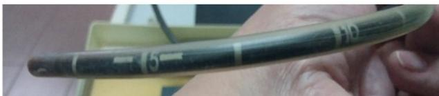
**Рис. 1.** Общий вид ИК для *in vivo* дозиметрии в упаковке (а) и чувствительный объем ИК (б) крупным планом
