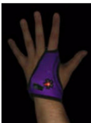
Рис. 4. а – Galvactivator, б – уровень яркости датчиков слушателей во время выступления
