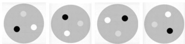
Рис. 4. Томограммы модели фантома, полученные при реконструкции по трехмерному алгоритму
