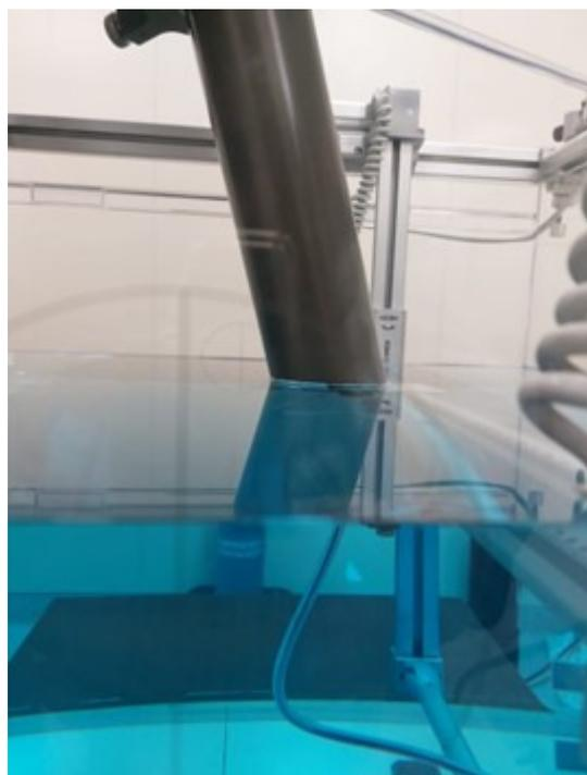
Рис. 5. Аппликатор 30°. Ось скошенного аппликатора не перпендикулярна поверхности воды, край соприкасается с поверхностью
