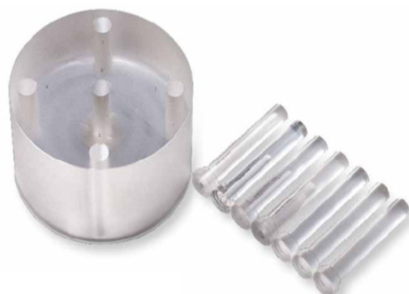
Рис. 2. Цилиндрический фантом с адаптерами (рядом) для ИК и эндостатов. По периметру отверстия для установки адаптеров эндостатов источников
