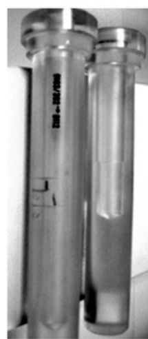
Рис. 5. Нанесение отметок о положении источника в боковом гнезде адаптера ИК – а, ТЛД в капсуле на дне гнезда адаптера в положении, соответствующем выбранному положению источника – б
