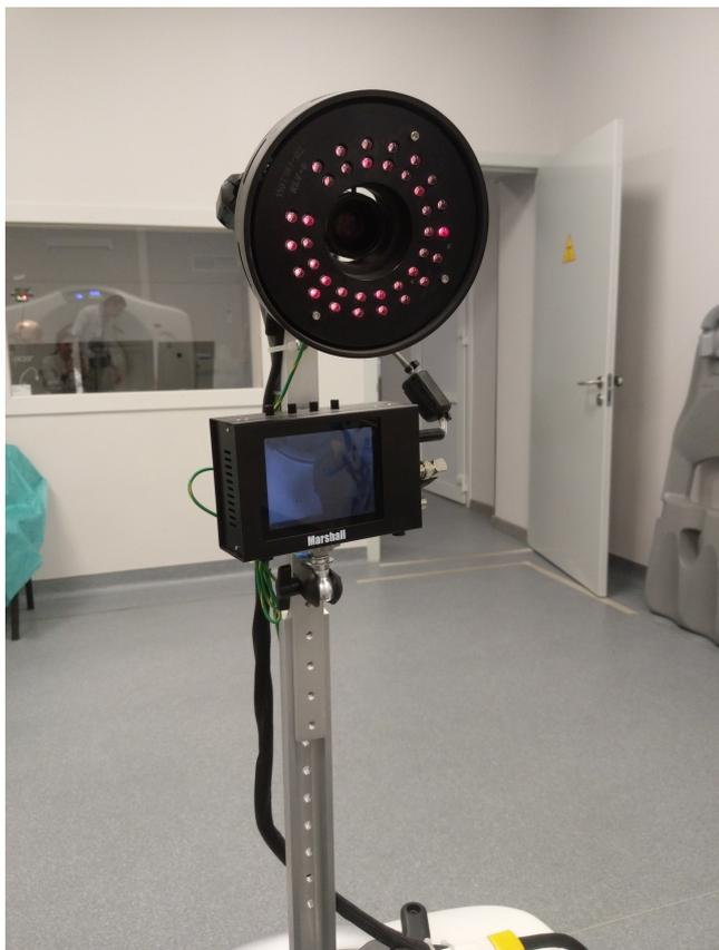
**Рис. 2.** Внешний вид камеры системы отслеживания дыхательных движений
