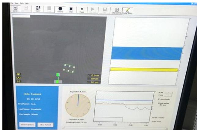
**Рис. 3.** Интерфейс программы RPM Respiratory Gating. Слева сверху транслируется изображение с камеры, зелёной рамкой выделен датчик дыхательных движений. Жёлтая полоса справа соответствует положению датчика, синяя полоса – выбранная при топометрической подготовке глубина вдоха. Справа внизу пространство между синей и оранжевой линией соответствует выбранной при топометрической подготовке глубине вдоха, чёрная линия – дыхательной кривой в течение записи
