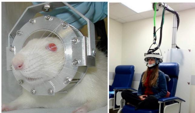
Рис. 13. ПЭТ-сканеры для крысы [24], и амбулаторные Helmet\_PET для человека [25]
