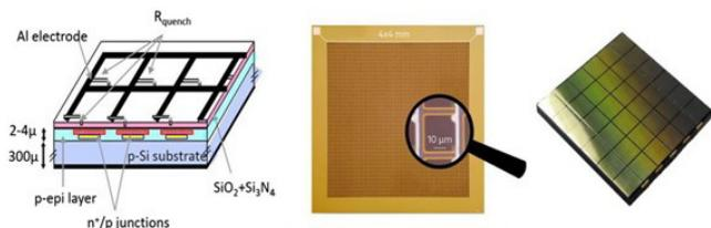
Рис. 7. Принцип работы SiPM [6]
