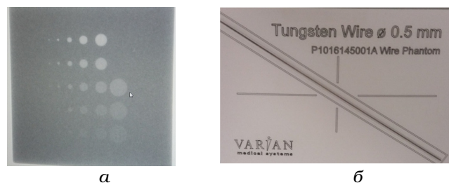
Рис. 5. а – характеристики контрастности полученного изображения отверстий в фантоме и б – фотография специального фантома для обнаружения и оценки качества изображения тонких предметов (вольфрамовая нить диаметром 0,5 мм)
