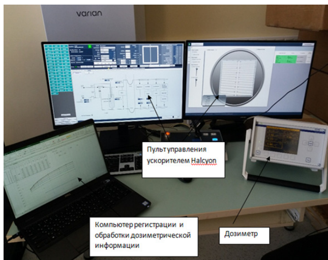
Рис. 6. Съемка дозиметрических характеристик ускорителя Halcyon™. Слева на экране компьютера факторы выхода
