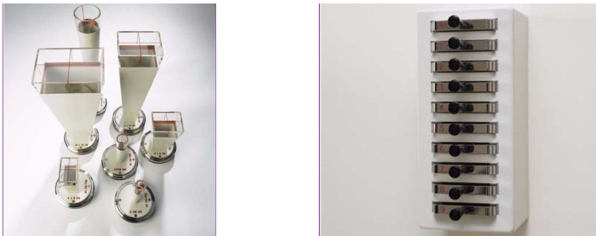
Рис. 3. а – общий вид аппликаторов рентгенотерапевтического аппарата XSTRANL 300, б – фильтры в соответствующих секциях
