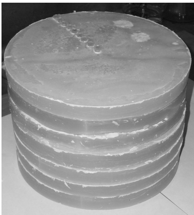
Рис. 1. Внешний вид (а) градуировочного фантома и КТ-изображение (б) пластины с пробирками, содержащими 15 мг/мл йода
