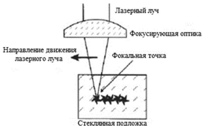
Рис. 1. Принцип локального разрушения стеклянных материалов лазерным излучением [4]
