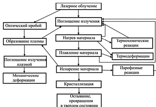
Рис. 2. Взаимосвязь физических процессов при воздействии лазерного излучения на материалы [7]
