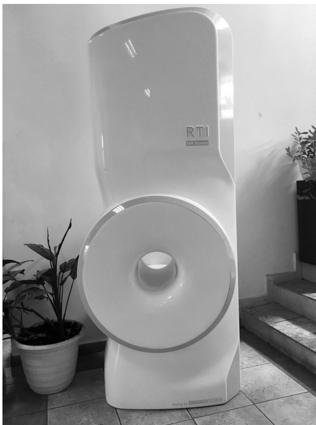
Рис. 2. Ортопедический сверхпроводящий магнитно-резонансный томограф “Эверест” с магнитной индукцией 1,5 Тл и безгелиевым охлаждением
