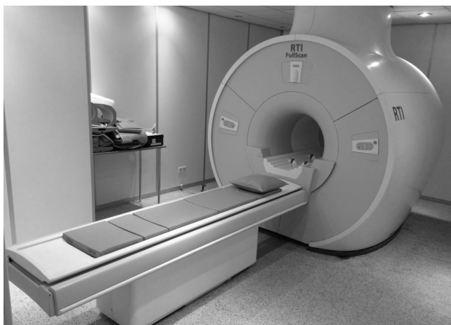
Рис. 1. Магнитно-резонансный сверхпроводящий томограф МРТ4.1 с магнитной индукцией 1,5 Тл
