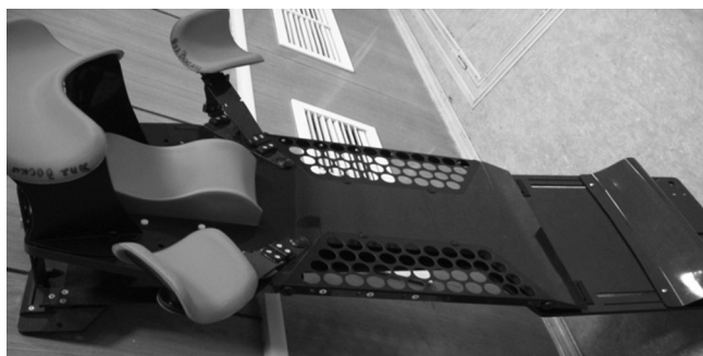
Рис. 4. Устройство, служащее для укладки грудной клетки и молочной железы с наклонной декой Posiboard
