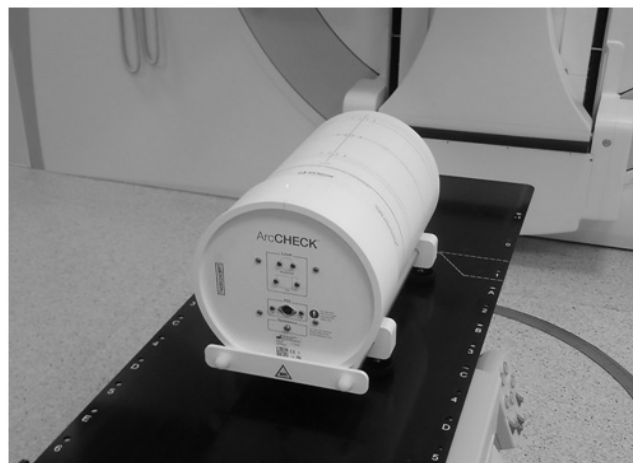
Рис. 1. Цилиндрический фантом ArcCHECK
