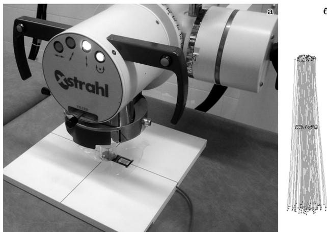
Рис. 3. а – постановка эксперимента по облучению радиохромных пленок с помощью рентгентерапевтической установки; б – визуализация расчетных траекторий фотонов, полученных в результате моделирования облучения радиохромной пленки рентгеновским излучением
