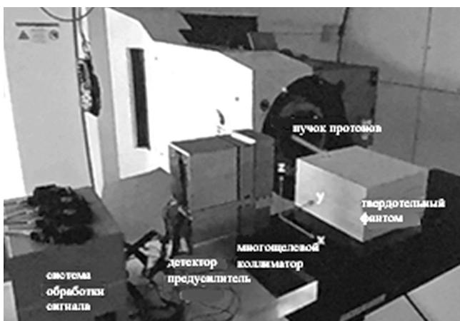
Рис. 5. Определение пробега пучка методом мгновенных (прямых) гамма-квантов
