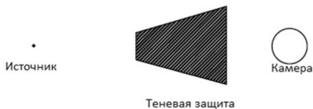
Рис. 1. Схема определения поправки на рассеяние методом теневой защиты
