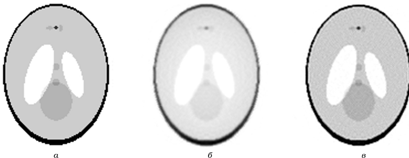
Рис. 7. Коррекция геометрического ослабления для фантома типа Шеппа-Логана: исходное изображение (а); изображение без коррекции (б); скорректированное изображение после 4 итераций корректирующего алгоритма с корректирующей матрицей (в)
