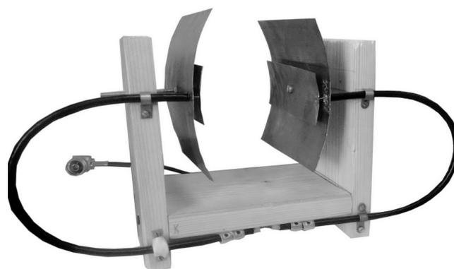
**Рис. 6.** Фотография экспериментального образца СВЧ-излучателя (без корпуса)
