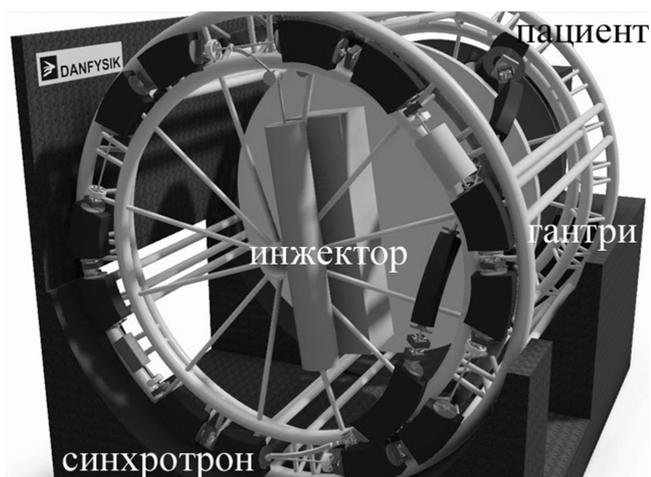
**Рис. 2.** Вид вращающегося синхротрона со стороны процедурной кабины
