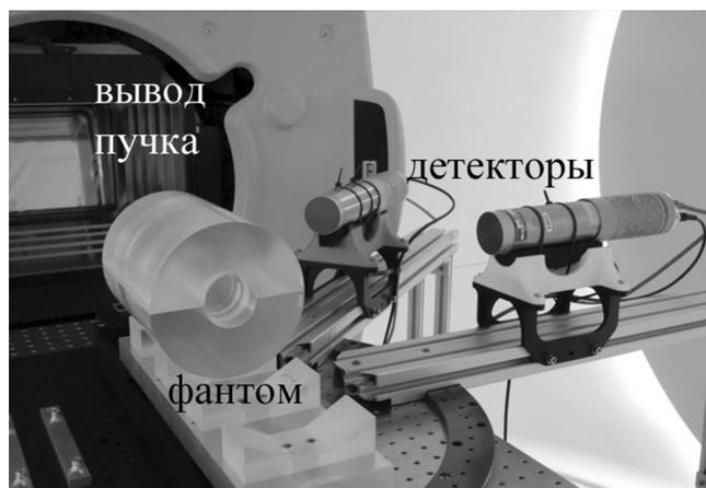
**Рис. 3.** Детекторы прямого гамма-излучения (OncoRay, Германия)
