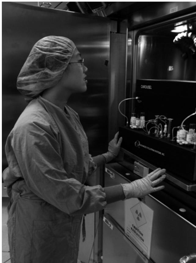
Рис. 2. Перед началом работы с модулем синтеза лаборант заправляет “горячую” камеру
