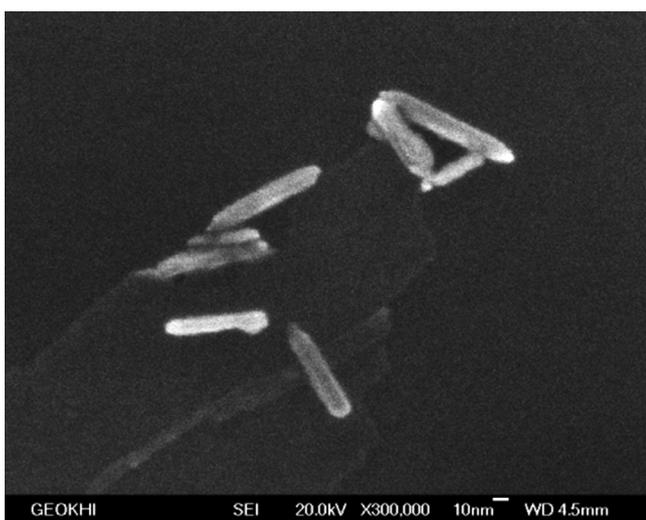
**Рис. 3.** Фотография наночастиц оксида цинка, полученных на сканирующем электронном микроскопе
