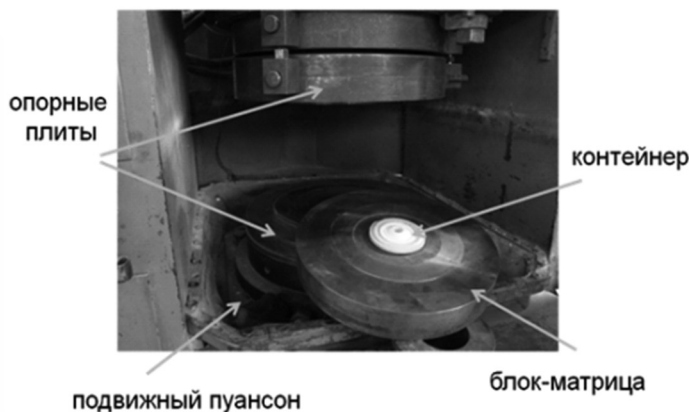
Рис. 4. Камера высокого давления тороид (слева) и рабочая зона прессовой установки ДО-040: 1 – ячейка из литографского камня, 2 – торцевые нагреватели, 3 – нитрид бора, 4 – графитовый нагреватель, 5 – смесь нитрида бора с хлоридом натрия, 6 – образец
