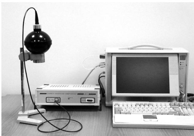
Рис. 4. Базовый модуль системы с камерой для контроля радиационной безопасности
