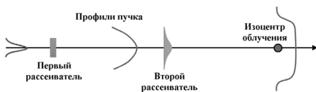
Рис. 2. Принцип метода двойного рассеяния
